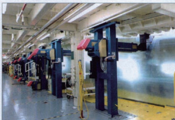
图4 波音747客机阵列式装配中的定位器
